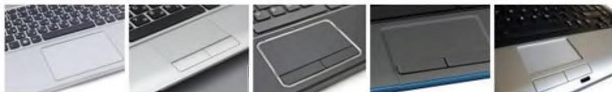
Поскольку работа устройства основана на измерении ёмкости, тачпад не будет работать, если водить по нему каким-либо непроводящим предметом, например, основанием карандаша. В случае использования проводящих предметов тачпад будет работать только при достаточной площади соприкосновения. Влажные пальцы затрудняют работу тачпада.
