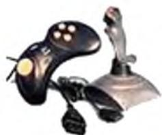
**Джойстик** - обычно это стержень-ручка, отклонение которой от вертикального положения приводит к передвижению курсора в соответствующем направлении по экрану монитора. Часто применяется в компьютерных играх.
