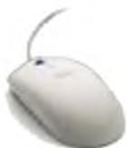
**Мышь** имеет вид небольшой коробки, полностью умещающейся на ладони. Мышь связана с компьютером кабелем через специальный блок - адаптер, и её движения преобразуются в соответствующие перемещения курсора по экрану дисплея. В верхней части устройства расположены управляющие кнопки (обычно их три), позволяющие задавать начало и конец движения, осуществлять выбор меню и т.п.
