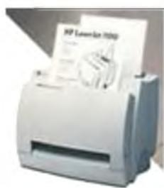
**Лазерные принтеры** работают примерно так же, как ксероксы. Компьютер формирует в своей памяти "образ" страницы текста и передает его принтеру.
