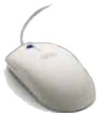
**Мышь** имеет вид небольшой коробки, полностью уместящейся на ладони. Мышь связана с компьютером кабелем через специальный блок - адаптер, и её движения преобразуются в соответствующие перемещения курсора по экрану дисплея. В верхней части устройства расположены управляющие кнопки (обычно их три), позволяющие задавать начало и конец движения, осуществлять выбор меню и т.п.
