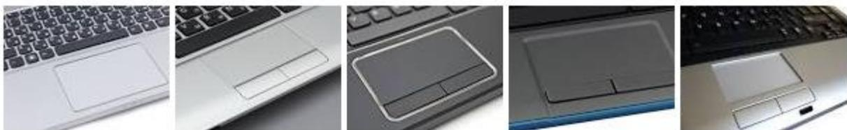
Поскольку работа устройства основана на измерении ёмкости, тачпад не будет работать, если водить по нему каким-либо непроводящим предметом, например, основанием карандаша. В случае использования проводящих предметов тачпад будет работать только при достаточной площади соприкосновения. Влажные пальцы затрудняют работу тачпада.
