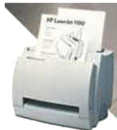
**Лазерные принтеры** работают примерно так же, как ксероксы. Компьютер формирует в своей памяти "образ" страницы текста и передает его принтеру.
