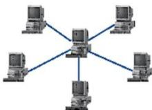
*Топология "Звезда"* схема соединения, при которой каждый компьютер подсоединяется к сети при помощи отдельного соединительного кабеля. Один конец кабеля соединяется с гнездом сетевого адаптера, другой подсоединяется к центральному устройству, называемому концентратором (hub).
