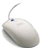
**Мышь** имеет вид небольшой коробки, полностью уместяющейся на ладони. Мышь связана с компьютером кабелем через специальный блок - адаптер, и её движения преобразуются в соответствующие перемещения курсора по экрану дисплея. В верхней части устройства расположены управляющие кнопки (обычно их три), позволяющие задавать начало и конец движения, осуществлять выбор меню и т.п.
