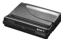
**Модем** - устройство для передачи компьютерных данных на большие расстояния по телефонным линиям связи.
