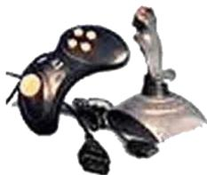
**Джойстик** - обычно это стержень-ручка, отклонение которой от вертикального положения приводит к передвижению курсора в соответствующем направлении по экрану монитора. Часто применяется в компьютерных играх.
